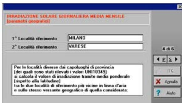
Per le località (minori) non comprese nei prospetti UNI10349, è possibile calcolare una irradiazione solare giornaliera (sul piano orizzontale) corretta che tenga conto della diversa localizzazione applicando il seguente criterio:
